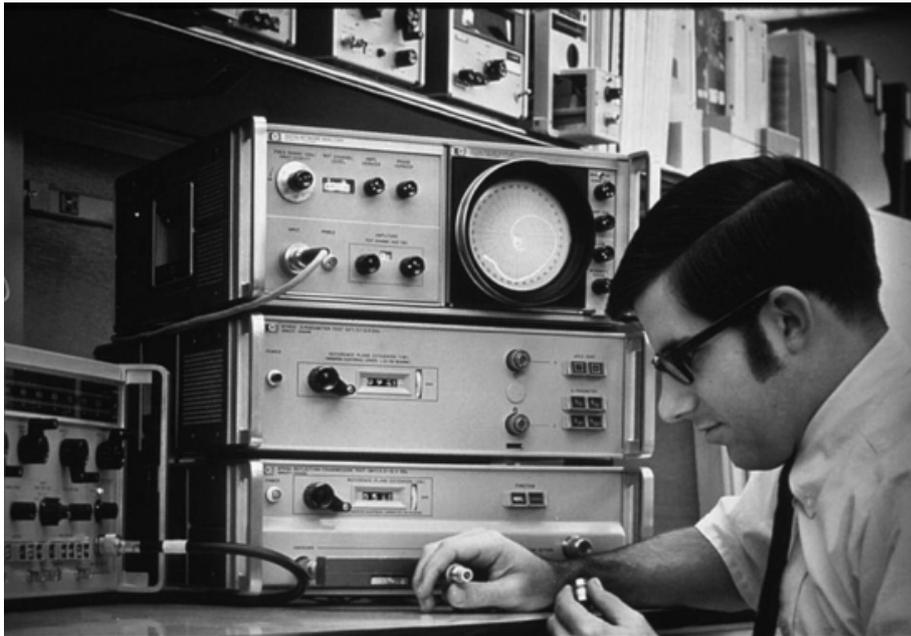
Figura 2.8: Analizador de redes de sobremesa HP 8410 [31].
