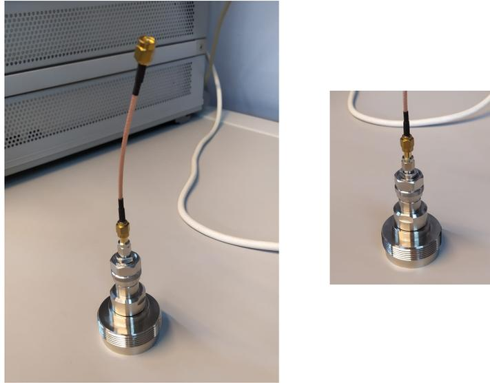
Figura 4.3: Cable coaxial SMA conectado a la sonda coaxial de final abierto.
