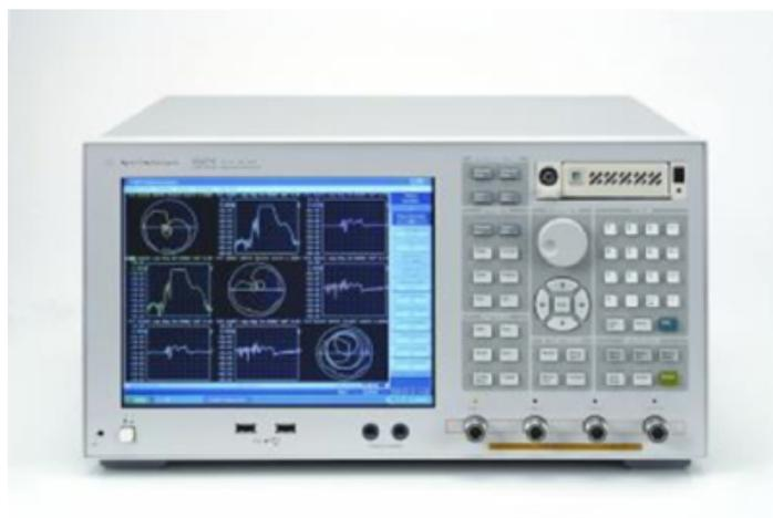
Figura 2.9: Analizador de redes vectorial de cuatro puertos [31].
