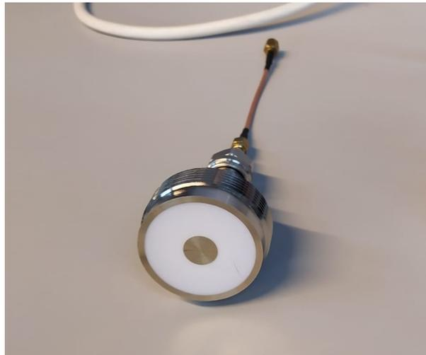
Figura 4.4: Sonda coaxial de latón y teflón de final abierto.
