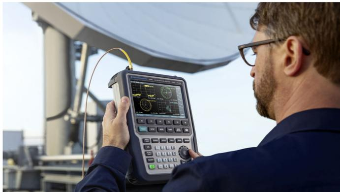
Figura 2.10: Analizador de redes vectorial portátil.
